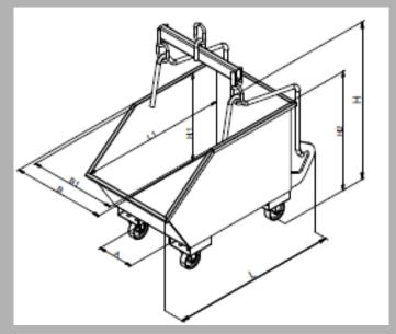
Benne à déchets de largeur inférieure à 83 cm pour le passage de portes lors de rénovation de bâtiments. Elle peut être déplacée et vidée par le grutier seul.
