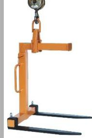
Ecartement réglable manuellement en continu de 450 à 950 mm. Hauteur utile réglable par cheville enfichable de 1150 à 1750 mm. Attention: le centre de gravité de la charge ne doit être en aucun cas supérieur à la mi-longueur des fourches.
