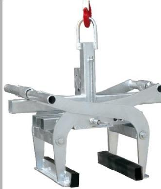
Pour le transport et la pose sécurisée de bordure. Pince à usage universel avec une grande zone d'ouverture réglable (0 à 550 mm) et une profondeur record de 180 mm. Peut être utilisée avec des oeillets d'accrochage pour crochet de grue ou poignée manuelle. Patins en caoutchouc remplaçables. Ouverture réglable avec dispositif de verrouillage à ressorts. Système d'automatisme "ouvert - fermé".
