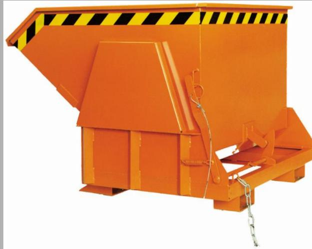
Cette benne basculante a pour avantage son point de rotation et la répartition de la charge. Soudée de façon étanche à l'huile et à l'eau, et disponible dans de nombreuses tailles. Avec bords de cuve renforcés, déclenchement à câble pour le basculement et protection contre le glissement et renversement intempestif. Peinture orange Eichinger (similaire à RAL 2000).
