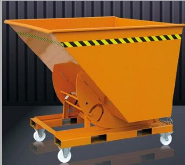
La benne rectangulaire avec un mécanisme de rotation/basculement offre un centre de gravité de la charge optimal. Les fourreaux pour fourches sont disposés multi-prises dans un châssis robuste. La benne peut ainsi être enfourchée des 4 cotés. Avec renforcement des bords de la cuve, tirant à câble pour basculement mécanique et protection contre le glissement.
