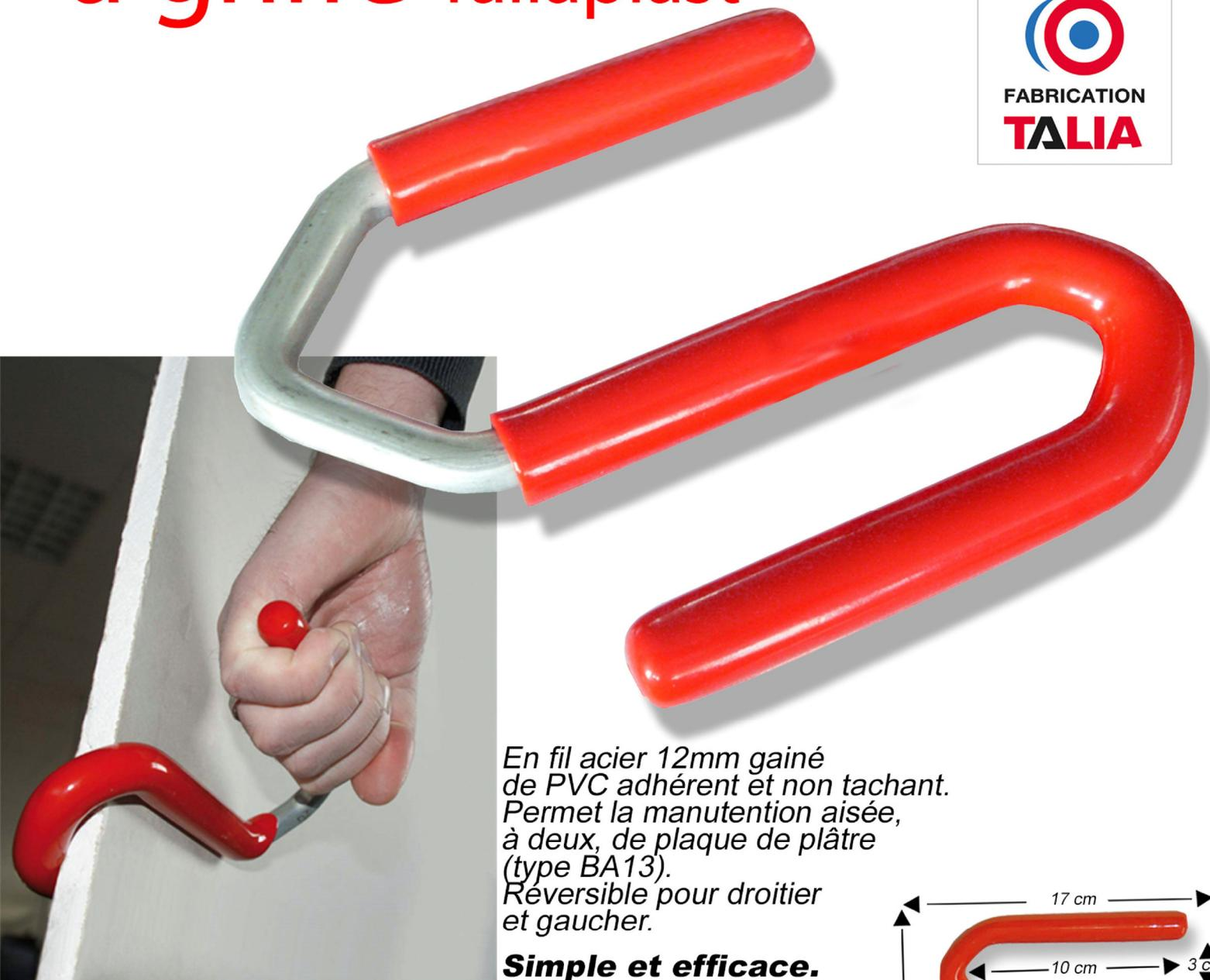
En fil acier 12mm gainé de PVC adhérent et non tachant. Permet la manutention aisée, à deux, de plaque de plâtre (type BA13). Réversible pour droitier et gaucher.
